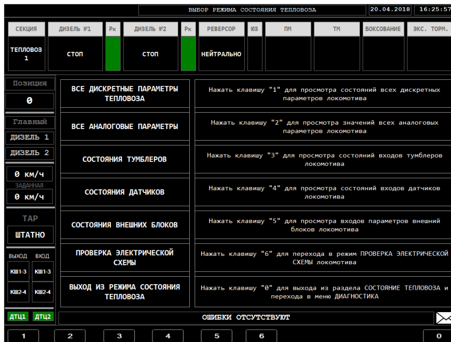
Рисунок 9 - Кадр РЕЖИМ СОСТОЯНИЯ ТЕПЛОВОЗА в разделе ДИАГНОСТИКА
