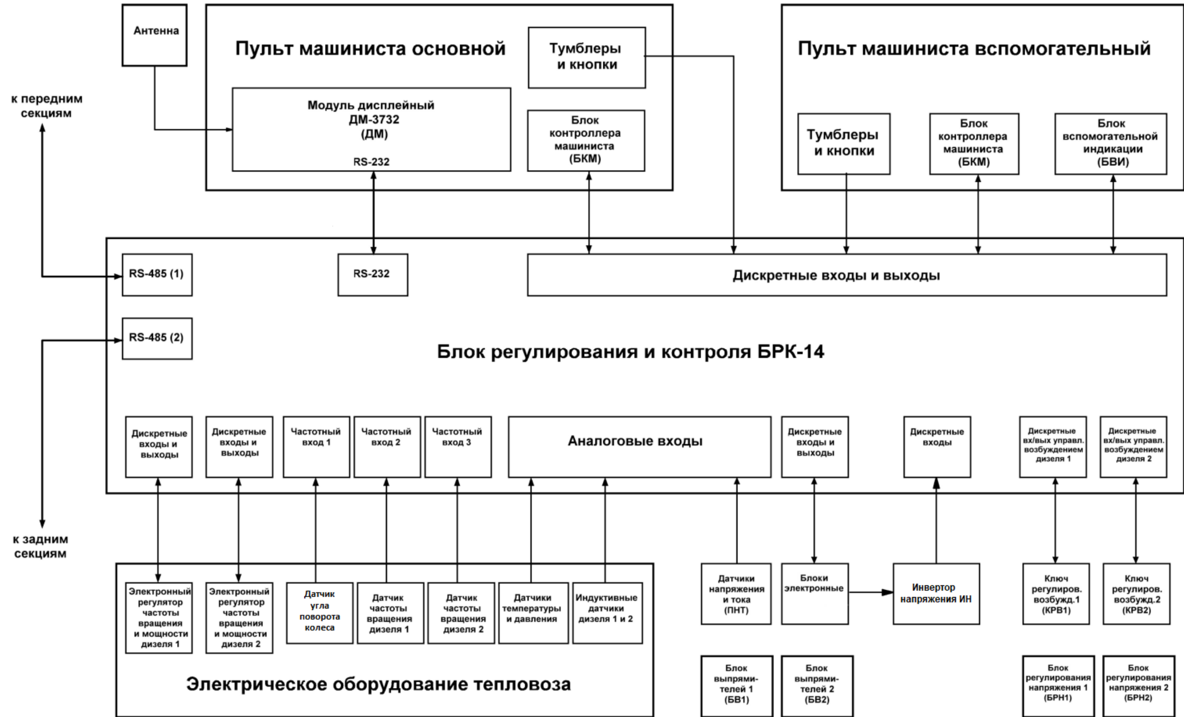
Рисунок А.1 – Структурная схема Системы для тепловоза ТЭМ14 с использованием ключа регулирования возбуждения КРВ-150АУ2П ЯТАУ.426471.004 и инвертора напряжения ИН ЯТАУ.435331.001
