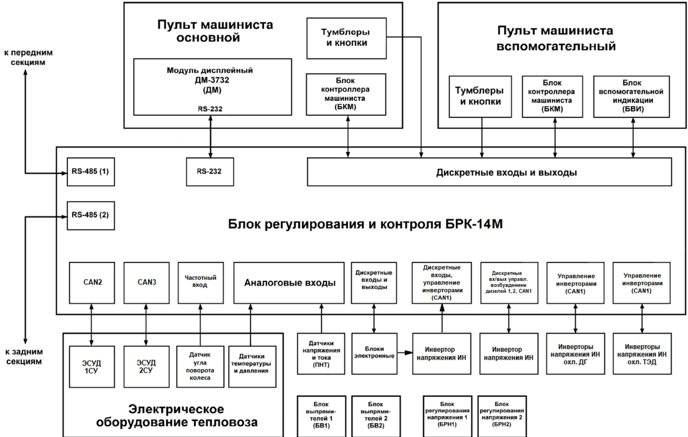
Рисунок А.3 – Структурная схема Системы для тепловоза ТЭМ14М
