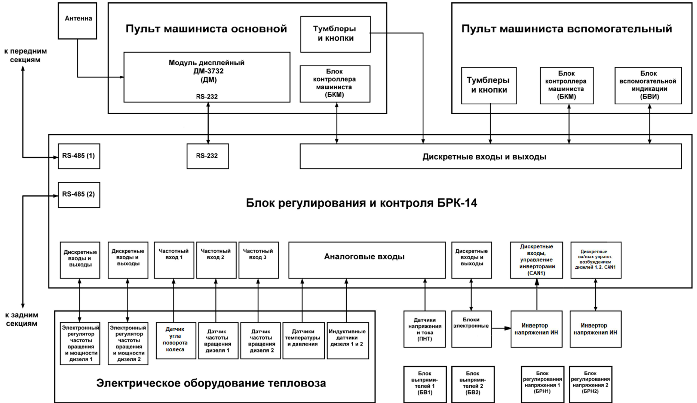
Рисунок А.2 – Структурная схема Системы для тепловоза ТЭМ14 с использованием инвертора напряжения ИН ЯТАУ.435331.001-02 и инверторов напряжения ИН ЯТАУ.435331.001-01
